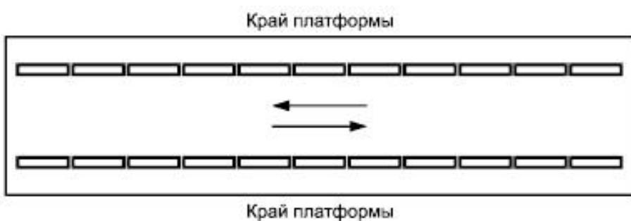
Рисунок А.4 - Форма рифления - одноэлементная тактильная полоса с плоской вершиной (шуцлингия), используемая для обустройства протяженных предупреждающих ТНУ вдоль края платформ различного назначения
