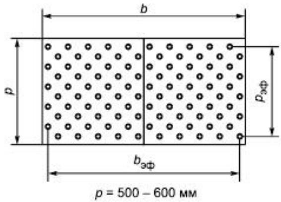
Рисунок А.2 - Форма рифления - усеченные конусы или усеченные купола, расположенные в шахматном порядке, используемые для обустройства предупреждающих ТНУ, запрещающих дальнейшее движение
